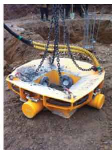
DESCABEZADOR DE PILOTES TAETS TIPO 5 Sección Cuadrada: 350mm - 500mm
