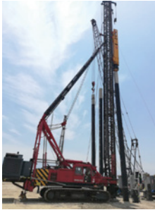
EQUIPO GUIADO HITACHI Long. Max. Pilote: 22m Peso Max. Pilote: 12 Tons Mastil: 36m
