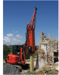
PERFORADORA GEAX DTC 30 Torque: 28 kgm Prof. Max. 15 m Ø Diámetro: 40-80 cm
