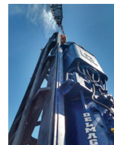
MARTILLO DE IMPACTO DELMAG D46 Tipo: Diesel Piston: 4.6 tons.
