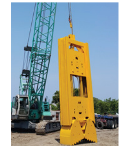
ALMEJAS HIDRAULICAS Y MECANICAS PARA MURO MILAN Espesor Hidráulica: 300mm -450mm Espesor Mecánica: 400mm - 1000mm Apertura: 1.8m - 2.60m
