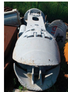
ALMEJA ESFERICA PARA EXCAVACION Ø Diámetro: 90cm
